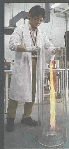
火災旋風の再現実験を行う豊橋技術科学大の中村准教授。空気の流れにより、炎の渦が1層ほどの高さに達した
